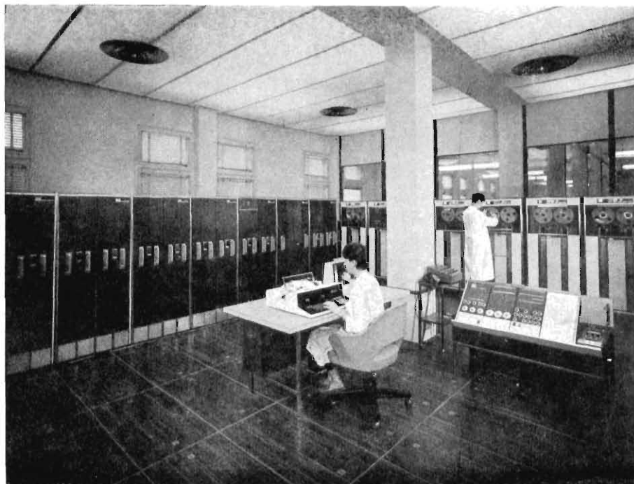
Fig. 3 - Il Centro elettronico della RAI. L'elaboratore elettronico IBM-7070 che la RAI-Radiotelevisione Italiana utilizza per l'amministrazione degli abbonati alla televisione. Di fronte: l'unità centrale; al centro: la console di comando; a destra: le unità nastro.
